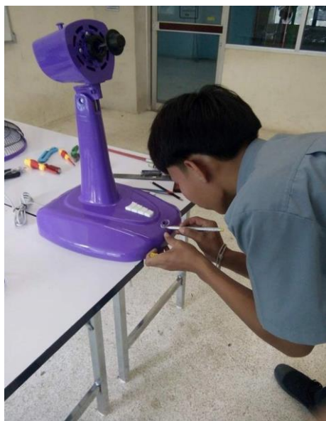
ทำการมาร์ตำแหน่งอุปกรณ์ต่างๆ ลงบนตัวพัดลม และเจาะเพื่อติดตั้งอุปกรณ์
